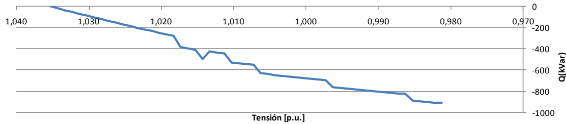
Figura 31: Curva Q-V para punto de conexión El Maitén considerando desconexión intempestiva de U1 de central El Traro en escenario de demanda máxima Abril 2012.
